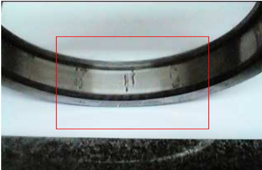
PISTA EXTERNA DO ROLAMENTO NU-322 APRESENTANDO SINAIS DE OXIDAÇÃO.
