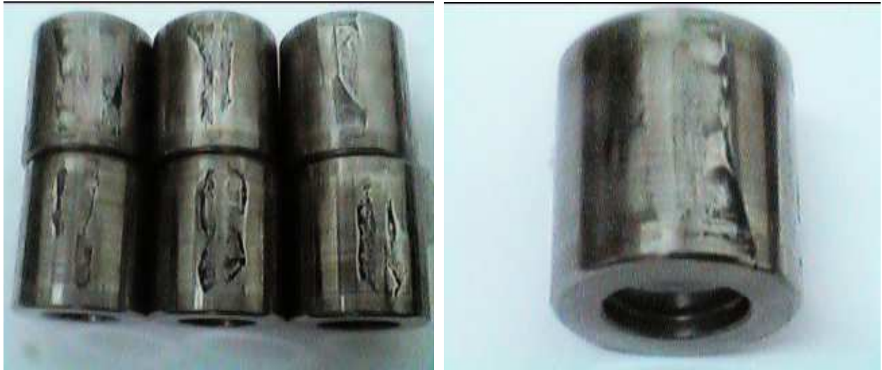
ROLOS DO ROLAMENTO NU-322 APRESENTANDO OXIDAÇÃO E DESCASCAMENTO
